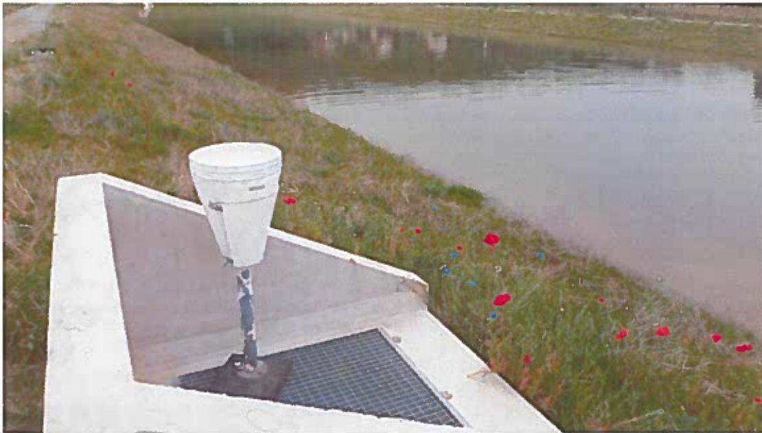
Figure 2 : Pluviomètre installé en bordure du bassin.
