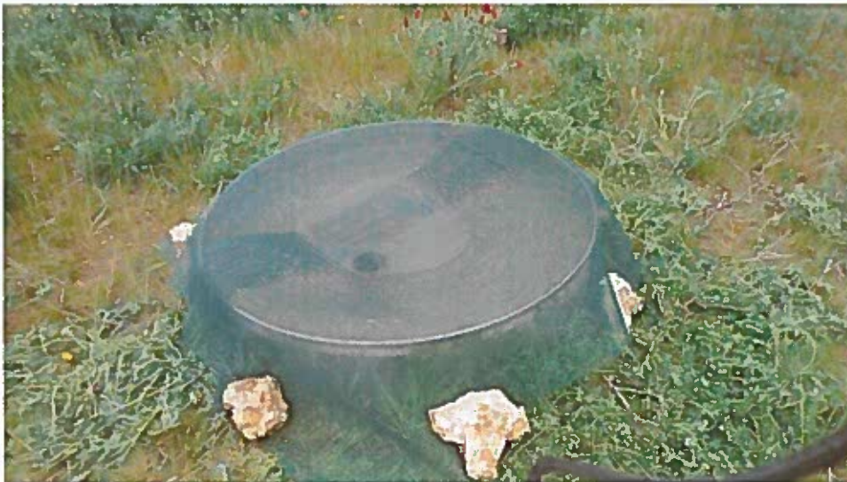
Figure 3 :Bac pour la mesure d'évaporation (recouvert pour éviter l'éventuelle influence d'animaux)
